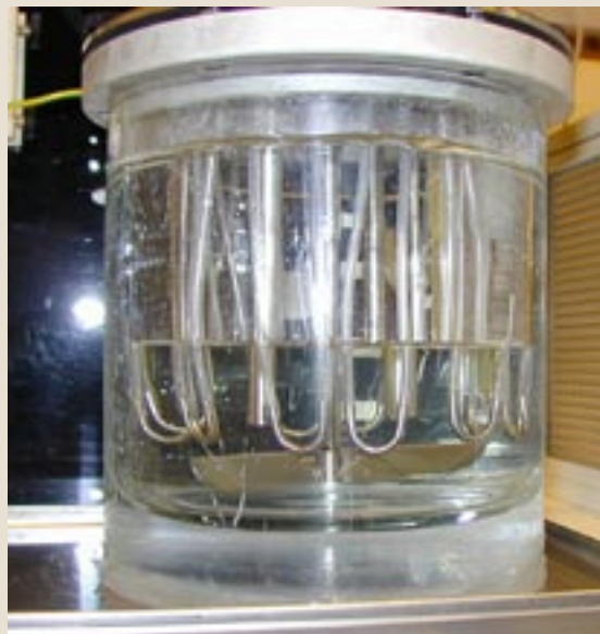
Moderne bioreaktor med en cellekultur i flytende næringsmedium. Foto: A.K. Hvoslef-Eide.
